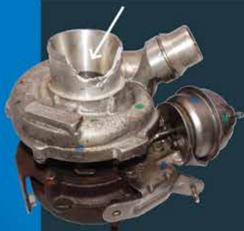
Slomljene montažne ušice/prirubnice
